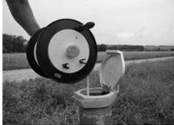
Abb. 1a: Grundwassermessstelle Abb. 1b: Ablesung mit Lichtlot
