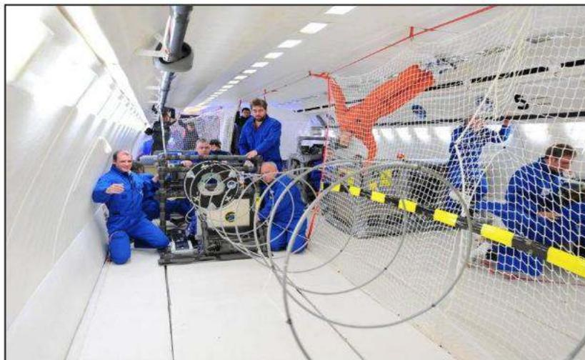
Abbildung 2: Entfaltete Antenne während des Parabelfluges
